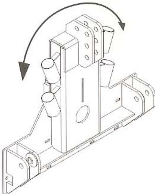
Pflüge mit einfacher Pendelbewegung folgen der Neigung quer zur Fahrtrichtung. Die einfache Pendelbewegung erfolgt bei den Holms Pflügen mithilfe einer zentral platzierten Gummibuchse. Der maximale Ausschlag beträgt  $\pm 9^\circ$ . Die gewählte Gradzahl (Pendelausschlag) ergibt sich aus der Anpassung an die Neigung des Gefälles/der Straße und der „Schrägstellung“ in Transportposition.
