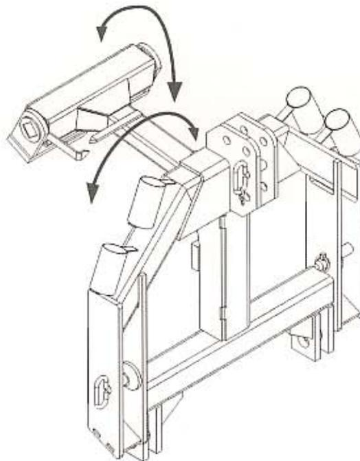
Bei der doppelten Pendelbewegung folgt der Pflug der Neigung sowohl quer zur Fahrtrichtung als auch in Fahrtrichtung. Für den Fahrer bedeutet dies einen bequemeren und ruhigeren Lauf bei gleichzeitig besserem Räumergebnis, besonders in stark hügeligem Gelände. Holms Pflüge führen die Pendelbewegung in Fahrtrichtung mit Hilfe von im patentierten Holms Floatarm™ montierten Gummibuchsen aus.
